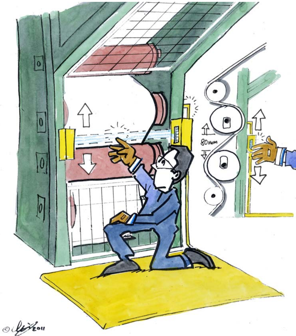
Bild 2: Bei Unterbrechung des Lichtstrahls werden die Walzen auseinander gefahren
